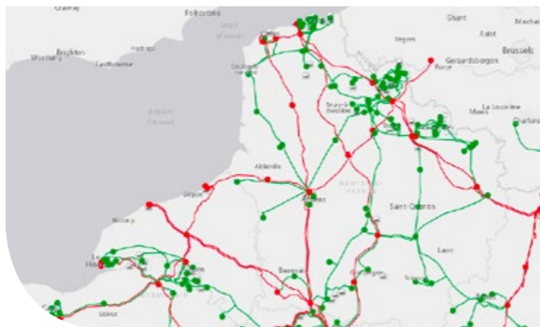
Réseau de transport d'électricité en Hauts-de-France en Octobre 2017 : - Les ouvrages (lignes, postes électriques) en projet ayant obtenus une déclaration d'utilité publique (DUP). - Les infrastructures existantes : lignes haute et très haute tension, centrales de productions En rouge : lignes THT en 400 000 Volts En vert : lignes THT en 225 000 Volts
